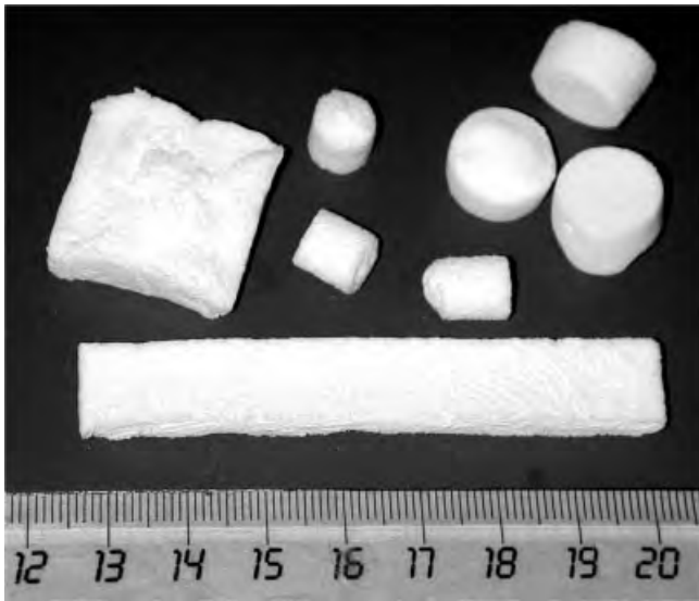
Abb. 1. Poröse Scaffolds aus mineralisiertem Kollagen in verschiedenen Größen und Formen (Maßstab im Bild: Zentimeter)
